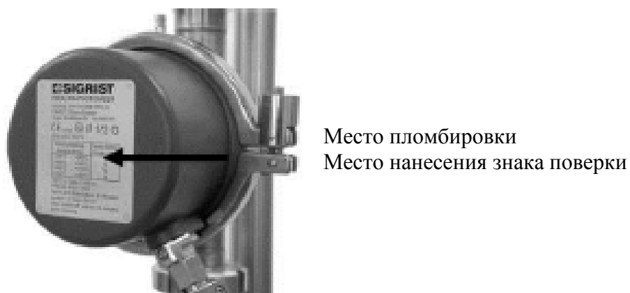
Рисунок 4 – Схема пломбировки и обозначение места нанесения знака поверки на анализатор мутности модели DualScat Ex
